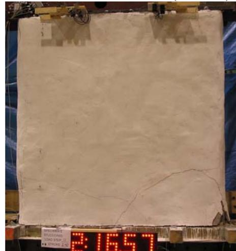
(d) Flexural cracks in Wall E (2.5% drift)
